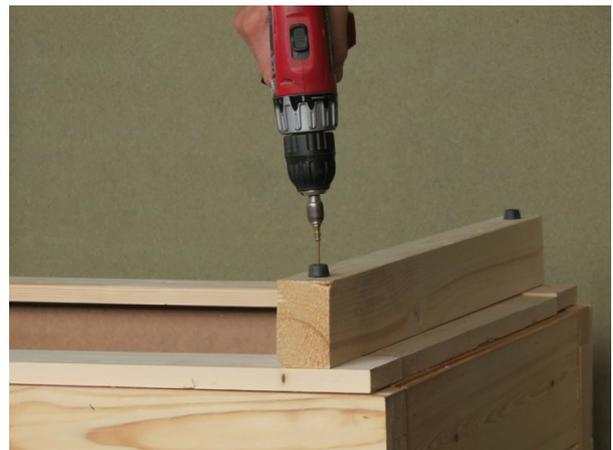
Setzen Sie das Unterteil auf den Katzenhauskörper und richten Sie es aus. Verschrauben Sie das Unterteil mit den beiliegenden 60 mm Schrauben. An den kurzen Seiten mit je 1 Schrauben an den langen Seiten mit je 2 Schrauben. Zum Schluss verschrauben (60mm) Sie die 4 GummifüÙe gleichmäÙig auf die Kanthölzer
