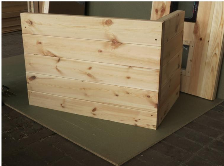
Der Katzenhauskörper wird mit je 2 x 90 mm Schrauben an den Ecken verschraubt.
